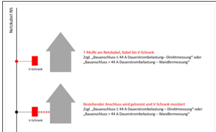
Abbildung 3: Fall 1: V-Schrankmontage an Längskabel, Fall 2: V-Schrankmontage an vorhandenen Netzanschluss (eigene Darstellung)
